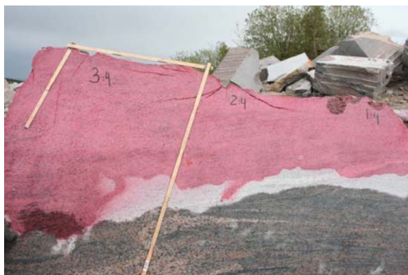
Figur 47: Sprickor hål 1-3, Dynotex, simultan initiering
