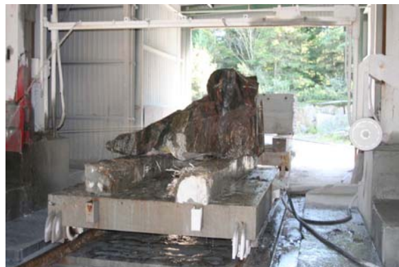
Figur 46: Linsågning av block
