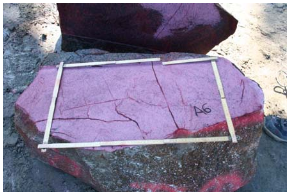
Figur 27: Hål A6, SSE 0,5 kg/m, Nonel
