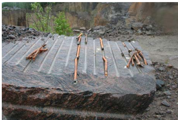
Figur 9: Utkastade, odetonerade Dynotextrör
