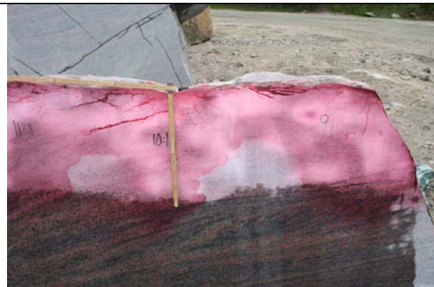
Hål 11:1-9:1 SSE 0,5 kg/m, simultan initiering
