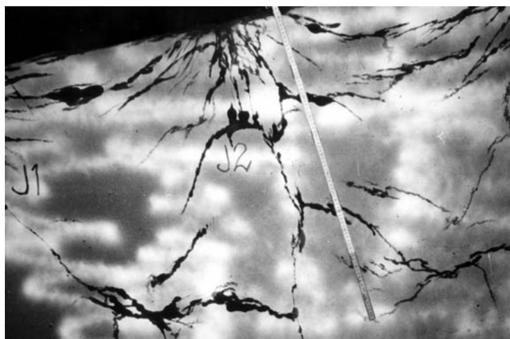
Figur 54: Bild från försök med \varnothing 22 mm Guritladdning i \varnothing 24 mm hål i Vånga
