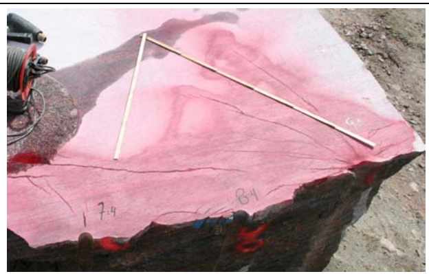
Hål 7:4-8:4 SSE 0,35 kg/m och hål 9:4 SSE 0,5 kg/m, simultan initiering
