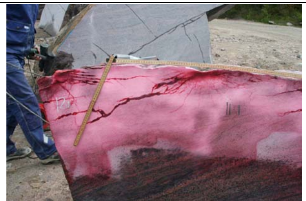
SSE 12:1-11:1 SSE 0,5 kg/m, simultan initiering
