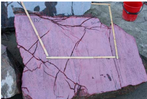
Figur 25: Hål D1-D2, SSE 0,35 kg/m, EPD
