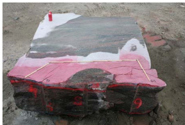
Figur 48: Sprickor hål 4-6, SSE 0,35 kg/m, simultan initiering
