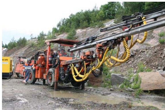
Figur 12: Borrhög Tamrock Minimatic
