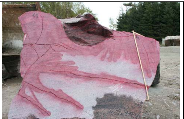
Hål 6:3 SSE 0,35 kg/m samt Hål 4:3 Dynotex, simultan initiering
