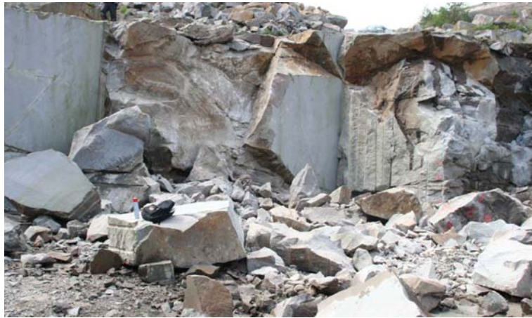
Figur 20: Sprängningsresultat, försök A, Nonelupptändning
