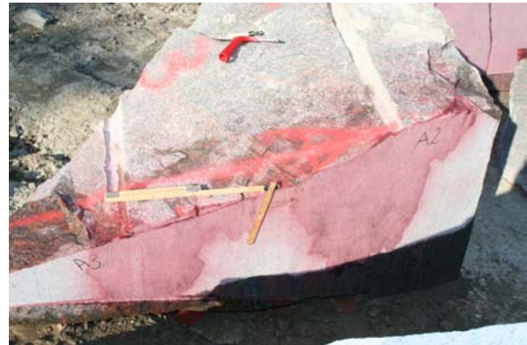
Figur 26: Hål A2-A3, SSE 0,35 kg/m, Nonel
