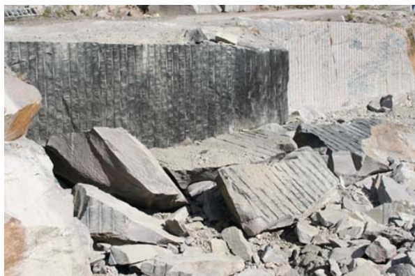
Figur 43: Resultat efter sprängning av tätsöm
