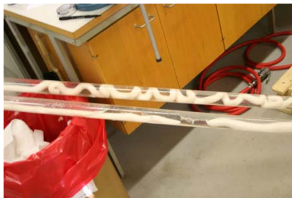
Figur 33: Strängladdning i vattenfyllt rör
