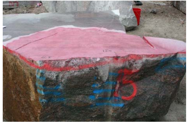
Figur 52: Sprickor bakom hål 15, SSE 0,35 kg/m, simulerad Nonel-initiering
