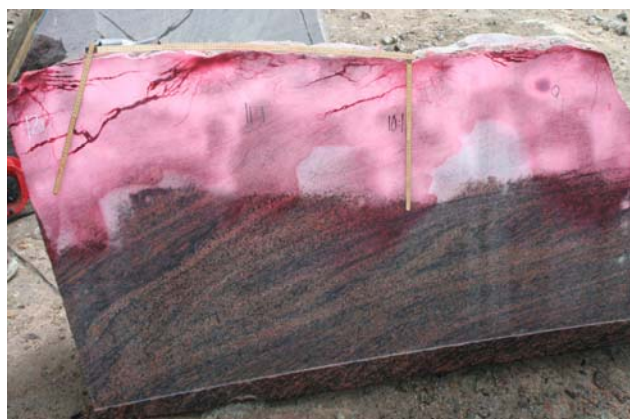
Figur 49: Sprickor hål 9-12, SSE 0,5 kg/m, simultan initiering
